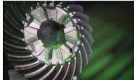
Les pièces qui servent à l'assemblage des embases sont usinées avec de très faibles tolérances et ce pour plus de résistance et fiabilité.
