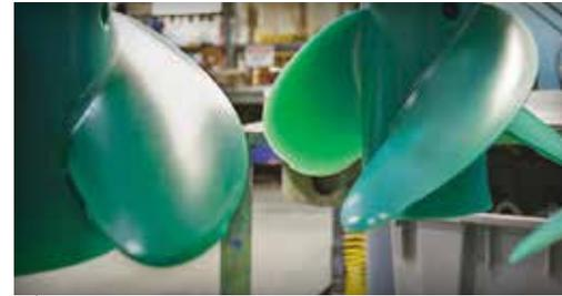
Mercury produit les meilleures hélices. La perfection des hélices Mercury provient de la précision des moules à usage unique qui servent à la fonderie des hélices.
