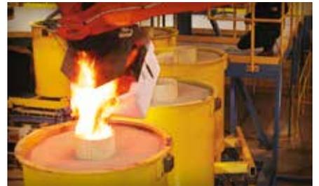
Le procédé, exclusif Mercury, de moulage sous pression par modèle perdu, permet de réaliser des formes complexes qui nécessitent moins d'assemblage procurant ainsi un gain de poids et une fiabilité accrue.
