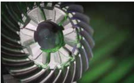
Les pièces qui servent à l'assemblage des embases sont usinées avec de très faibles tolérances et ce pour plus de résistance et fiabilité.
