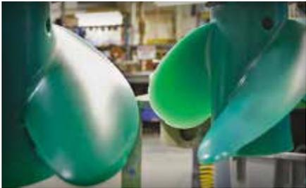
Mercury produit les meilleures hélices. La perfection des hélices Mercury provient de la précision des moules à usage unique qui servent à la fonderie des hélices.
