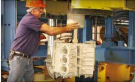
Le procédé, exclusif Mercury, de moulage sous pression par modèle perdu, permet de réaliser des formes complexes qui nécessitent moins d'assemblage procurant ainsi un gain de poids et une fiabilité accrue.
