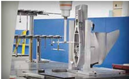
Tout au long de la fabrication et de l'assemblage des moteurs, des pièces sont prélevées de la chaîne de montage pour un contrôle permanent.
