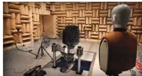
Dans le laboratoire d'acoustique Mercury, les ingénieurs analysent et optimisent la qualité sonore, afin d'atteindre des niveaux de bruit, de vibrations et de secousses (NVH) parmi les meilleurs au monde.
