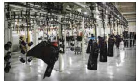
En utilisant des matériaux anticorrosion, la peinture se fait en plusieurs étapes, une exclusivité Mercury. Le procédé de revêtements permet aux 4-temps Mercury d'avoir une protection optimale contre l'eau salée.
