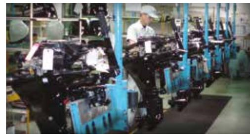
Après les tests, les techniciens installent l'hélice et le capot moteur, puis font des contrôles de qualités avant que le moteur soit conditionné pour le transport, vous assurant le nec plus ultra en matière de fiabilité.
