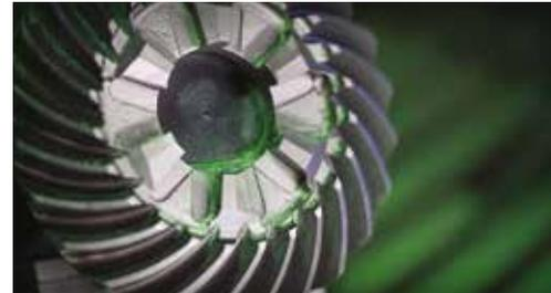
Les pièces qui servent à l'assemblage des embases sont usinées avec de très faibles tolérances et ce pour plus de résistance et fiabilité.
