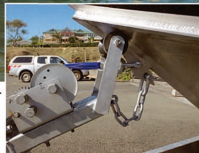
Ne vous fiez pas à la photo ci-dessus, un système de crochet permet d'arrimer automatiquement le bateau à sa remorque.
