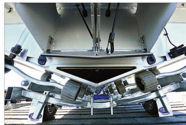
On distingue bien ici l'entrée de la cavité qui fait office de lest liquide. La trappe est actionnée depuis le cockpit. En mer, le remplissage et la vidange sont quasi instantanés.
