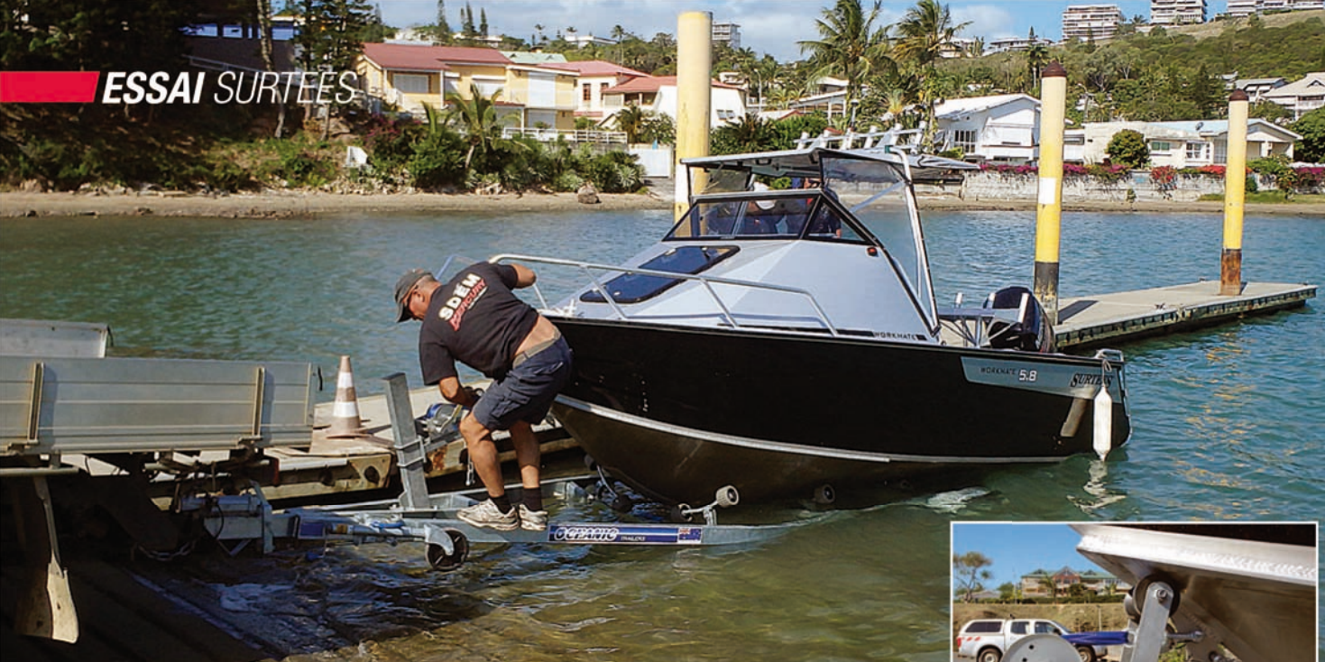
Ne vous fiez pas à la photo ci-dessus, un système de crochet permet d'arrimer automatiquement le bateau à sa remorque.
