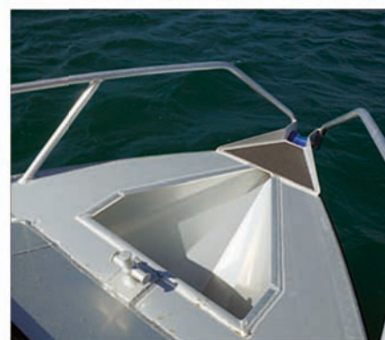
Dans sa version de base, la baille se passe de capot, limitant ainsi les risques de corrosion.
