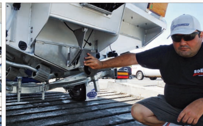
On distingue bien ici l'entrée de la cavité qui fait office de lest liquide. La trappe est actionnée depuis le cockpit. En mer, le remplissage et la vidange sont quasi instantanés.
